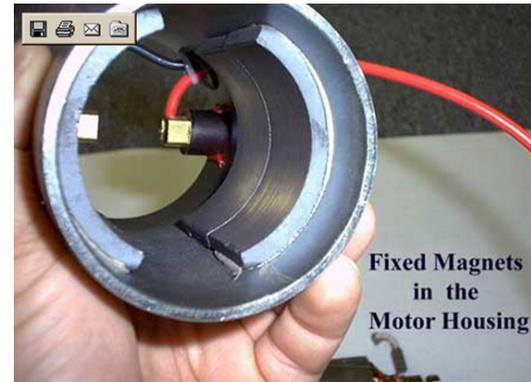
Статор – неподвижная часть мотора, оснащенная фиксированными магнитами. Это самая тяжелая часть любого мотора роторного типа.
